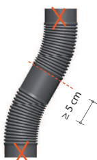
Abb. 7, flex. Rohr rechtwinkelig kürzen
